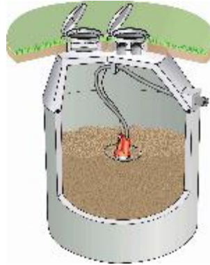
Abbildung 7: Erdlager aus Beton mit Saugentnahme von oben
