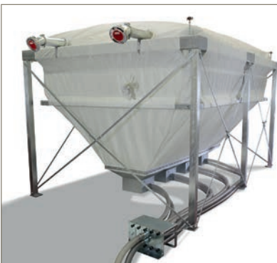
Abb. 12b: Konussilo in Modulbauweise
