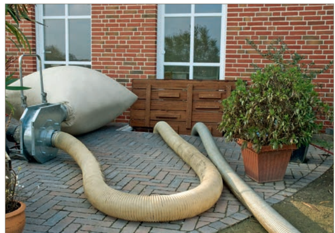
Abb. 4b: Absaugventilator mit Staubsack
