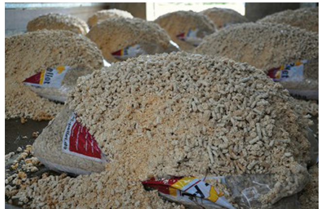
Abb. 10: In einem Versuch wurden Pellets mit Wasser übergossen.
