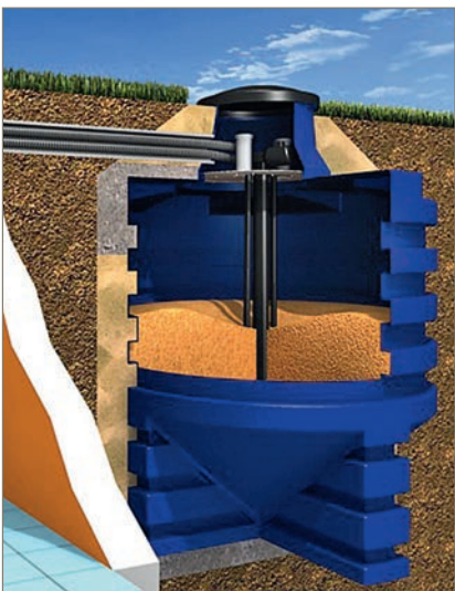
Abb. 19: Erdlager aus Kunststoff mit senkrechter Förderschnecke
