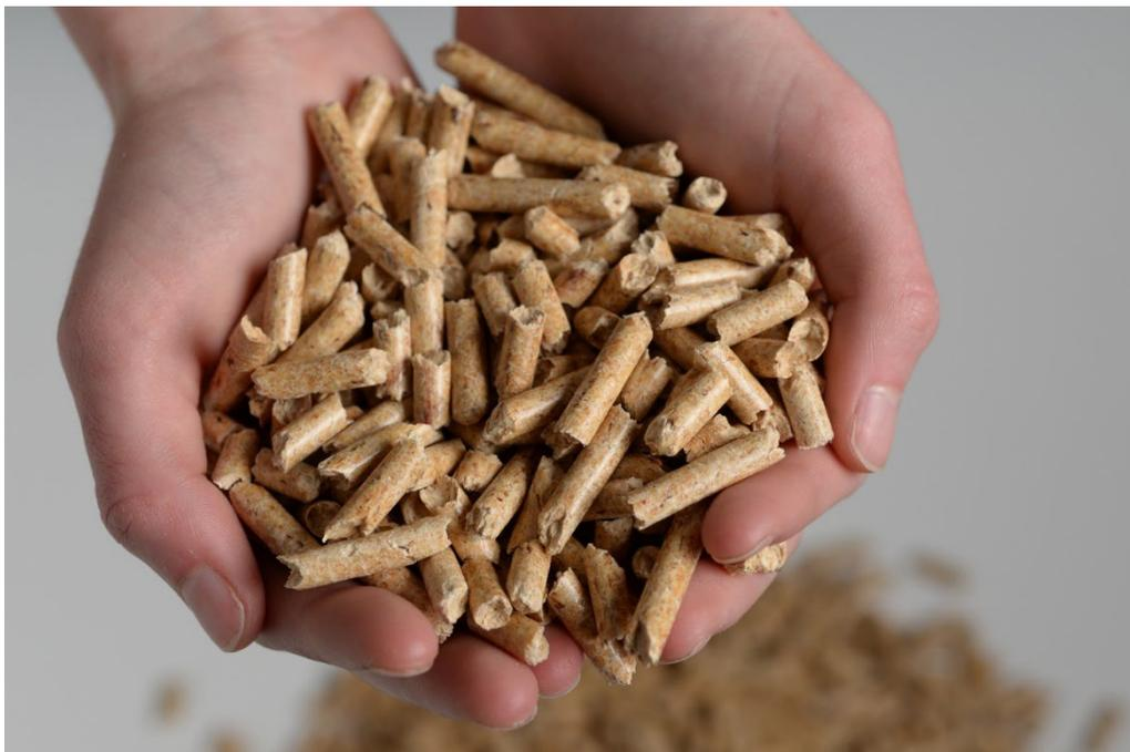
Pellets, produziert aus Restholz: Sägemehl und Hobelspänen.
