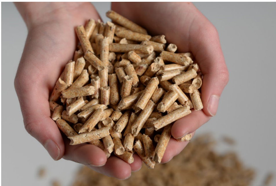
Granulés de bois produits par des résidus de bois : sciure et copeaux.
